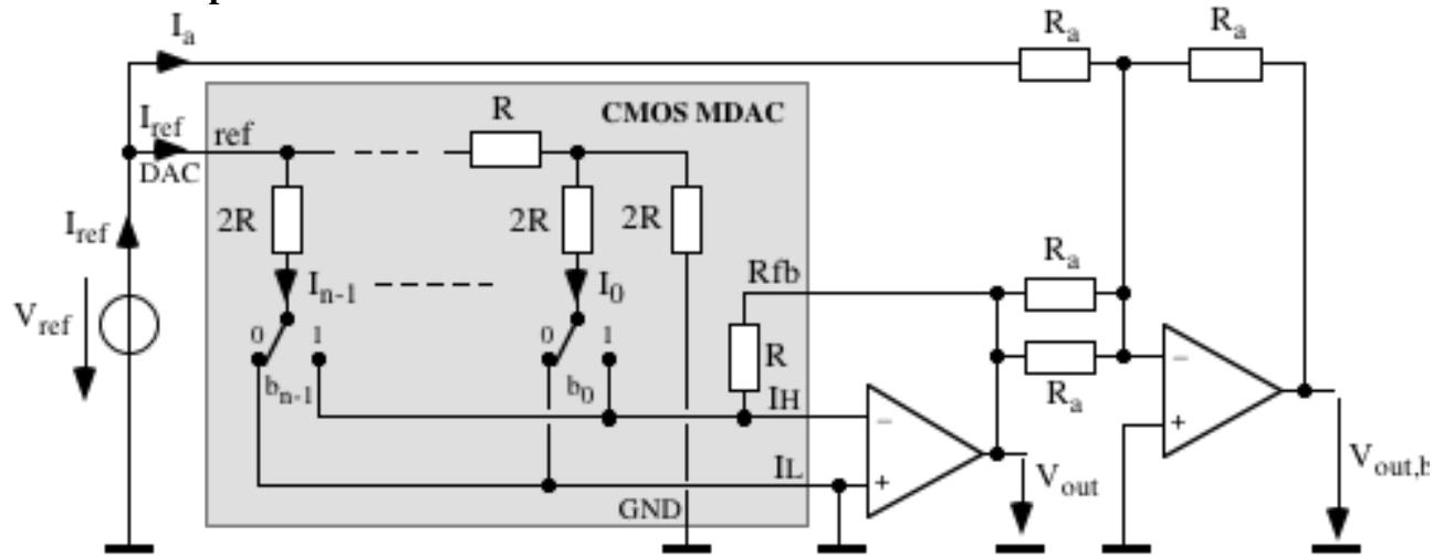
Etablir la relation liant  $V_{out,b}$  à  $V_{ref}$  et au code binaire ( $b_{n-1}, \dots, b_1, b_0$ ).
