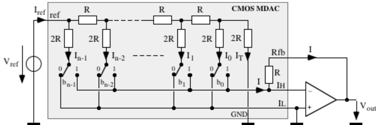
Etablir la relation liant  $V_{out}$  à  $V_{ref}$  et au code binaire ( $b_{n-1}, \dots, b_1, b_0$ ).
